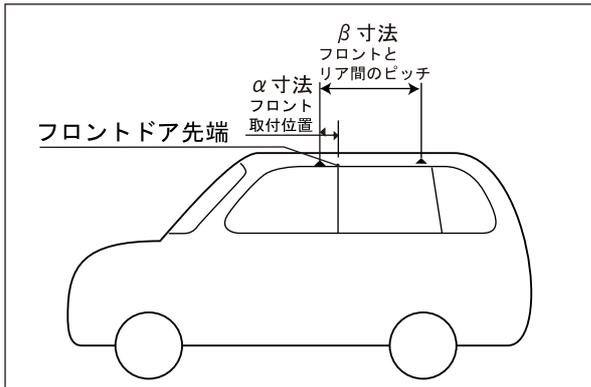
ルーフキャリアを取付指定位置以外に取付けると、固定力不足によりルーフキャリアが脱落し、後続車や人を事故に巻き込むおそれがあります。ルーフキャリアは、必ず取付指定位置に取付けてください。
