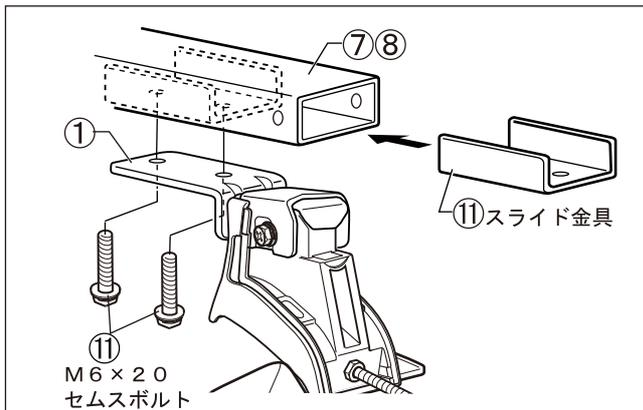
(1)フレーム角パイプ⑦⑧にスライド金具⑪の向きに注意して差し込み、脚 Assy ①を、M6 x 20セムスポルト⑪で仮組みします。
