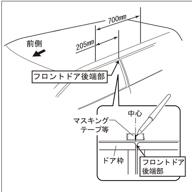
(1)フロントドア後端部にマスキングテープ等を貼付け、水性ペンでマーキングし、基準用とします。(2ヶ所)
