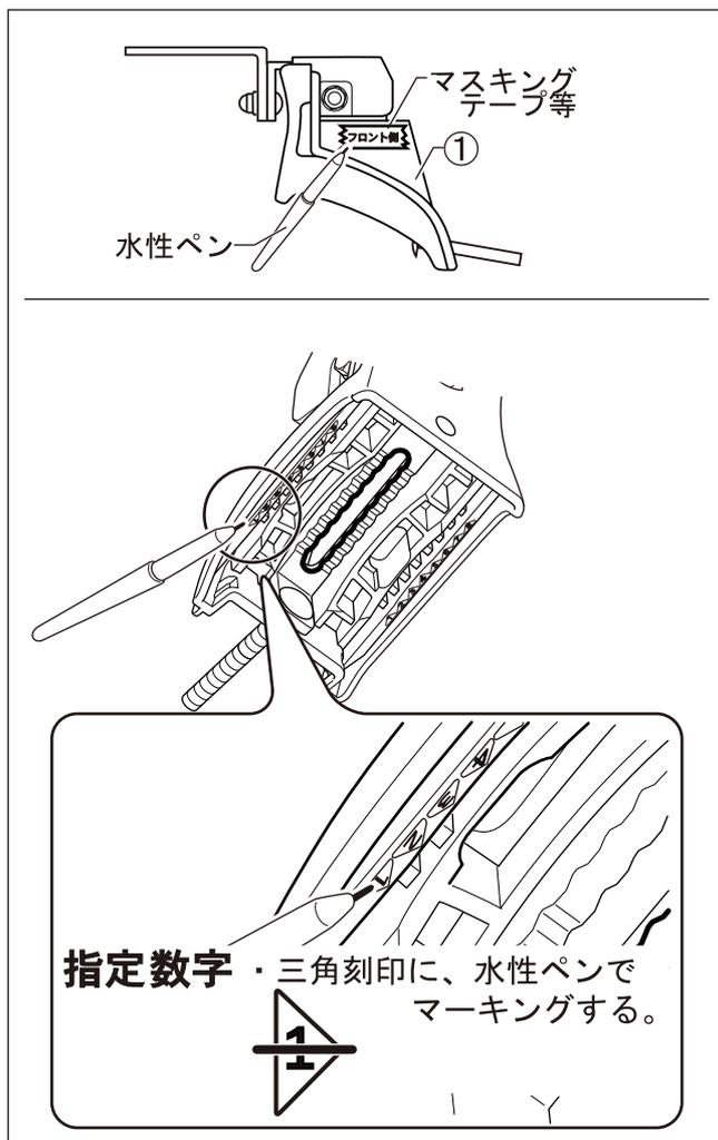
(1)脚 Assy ①にフロント、リヤの識別がわかるようにマスキングテープ等に水性ペンで印を付けます。
