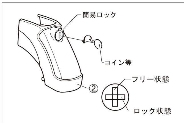
(1)コイン等で脚カバー②の簡易ロックに差し込み、90度（時計方向）まわすとロック状態になり、逆の作業でフリー状態になります。
