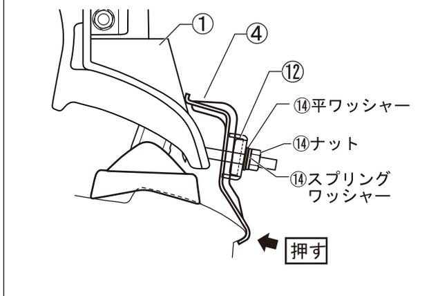
(1)フック④下部をルーフエッジ部に引掛け、長穴を脚のボルト部に差込みます。
