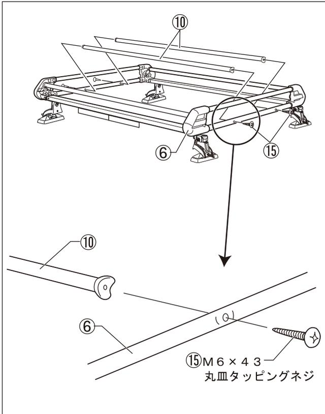
(1)横枠 Assy ⑥と中間パイプ⑩を、M6×43丸皿タッピングネジ⑮で締付け、固定します。
