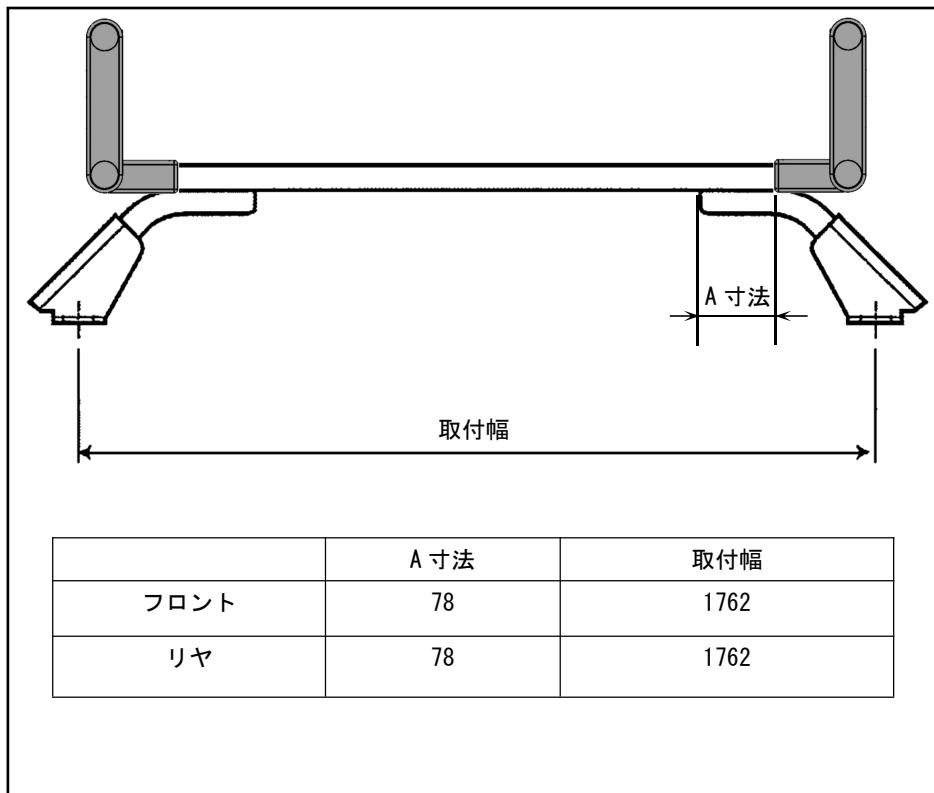
1 取付幅と A 寸法を測定し、「脚 ASSY」の位置を固定します。
