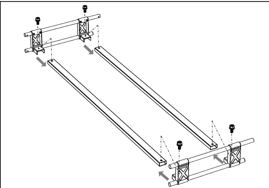
1 「フレーム ASSY」に「横枠 ASSY」を挿入し、M6×15 セムス六角ボルト⑭で固定します。
