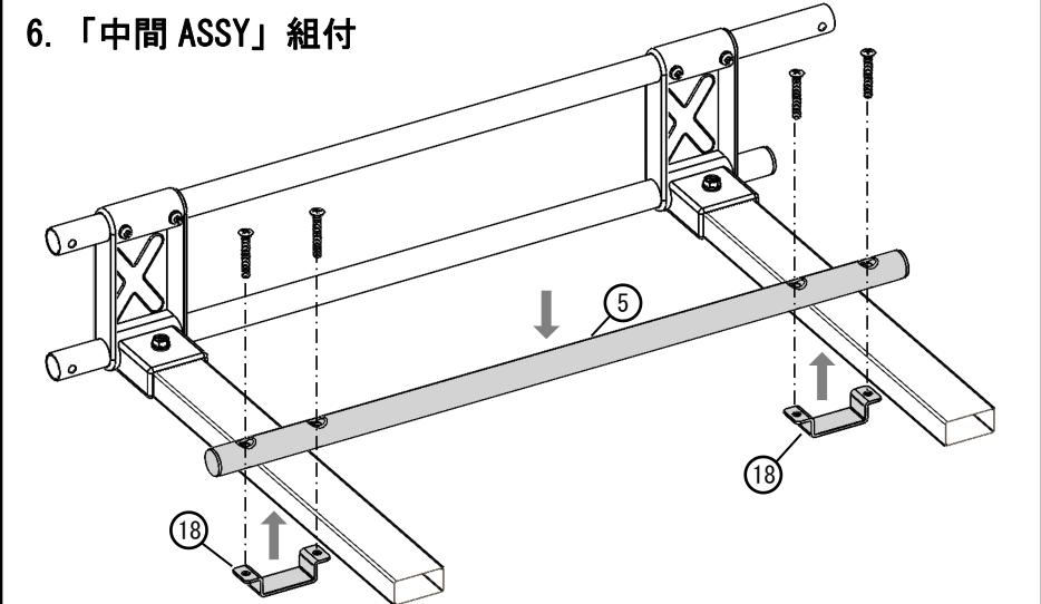
1 「中間 ASSY」を「フレーム ASSY」の上に置き、固定ブラケット⑯とM5×35 丸皿ネジ⑮で仮止めします。
